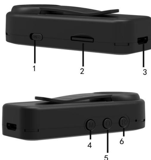
**1(ON). Bouton de interrupteur 2. Porte-cartes Micro SD 3.Interface de puissance 4(M). Interrupteur WiFi 5(O). Prenez une photo&Vision nocturne ON / OFF 6(R). Bouton vidéo / bouton de réinitialisation**
